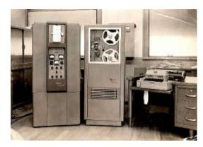
(写真は 1959 年に導入したコンピュータの Bendix G-15D です。)
