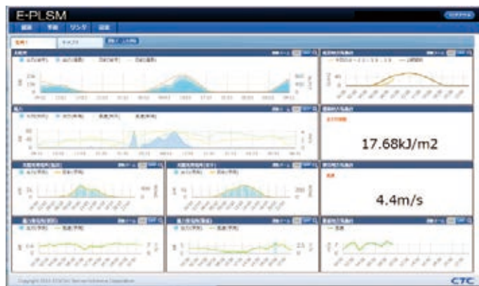
再生可能エネルギー発電所における発電量と気象(風量)情報とのモニタリング画面
