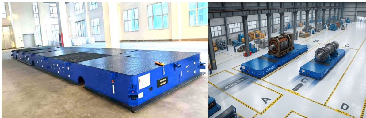
左:超重量物向け無人搬送車／右:大型製品・部品の自動搬送イメージ
