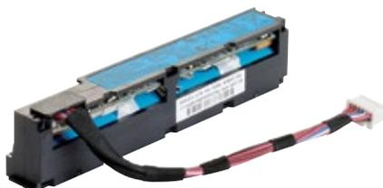
HPE ProLiant Gen10サーバーでは、大容量不揮発性メモリ「HPE 16GB NVDIMM」を超高速のストレージ領域として活用できます。HPE 16GB NVDIMMでは万一電源が失われた際にフラッシュメモリでデータを保護。「HPE Smart ストレージバッテリー」はこのデータ転送・保護を安全に行うための電源を供給し、最大16枚のNVDIMMモジュールをサポートします。
