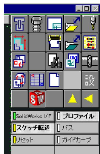
図形の種別を、図形選択前に『プロフィール』・『パス』・『ガイドカーブ』から指定します。図形選択は、ロフト、スイープなど、複数のスケッチ形状から構成される場合は、必要に応じて複数の図形グループを必要なだけ選択できます。
