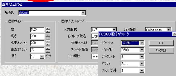
カメラ制御信号極性、スキャンモード、RS232C 通信
