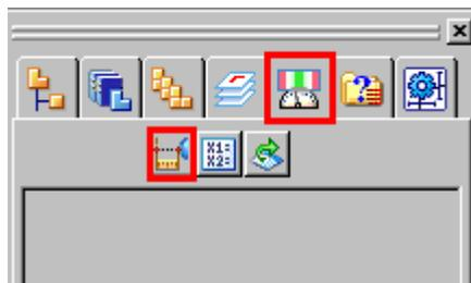
センサーで監視を行いたい面と面の最短距離を測定すると、現在の距離が測定された値として表示されます。
