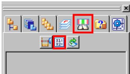
変数テーブルと「センサーのパラメータ」ダイアログボックスが表示されますので、変数テーブルからセンサーに設定したいセルを選択し、センサーのパラメータ内の変数を追加ボタンを選択します。
