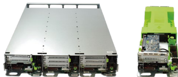
Wiwynn社のOCPサーバ製品。シンプルな構造で、ドライバーなど道具なしでパーツ交換が可能
