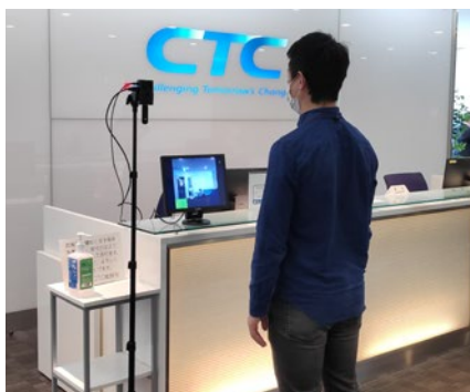
設置したデバイスから50cmほどの距離で1~2秒程度静止。非接触で体表面温度を測定
