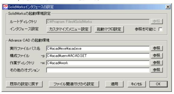
ダイアログボックスの上半分は、SolidWorks 関連、下半分は Advance CAD 関連の設定項目です。 以下、各設定フィールド、ボタンの機能を説明します。
