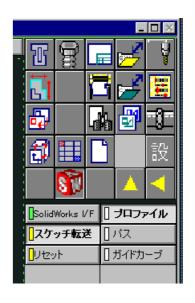
図形の種別を、図形選択前に『プロファイル』・『パス』・『ガイドカーブ』から指定します。図形選択は、ロフト、スイープなど、複数のスケッチ形状から構成される場合は、必要に応じて複数の図形グループを必要なだけ選択できます。
